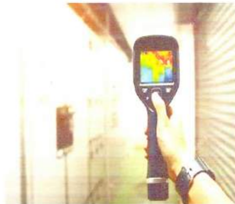
Gambar E.1. Ilustrasi Pemeriksaan menggunakan Thermal Imaging
