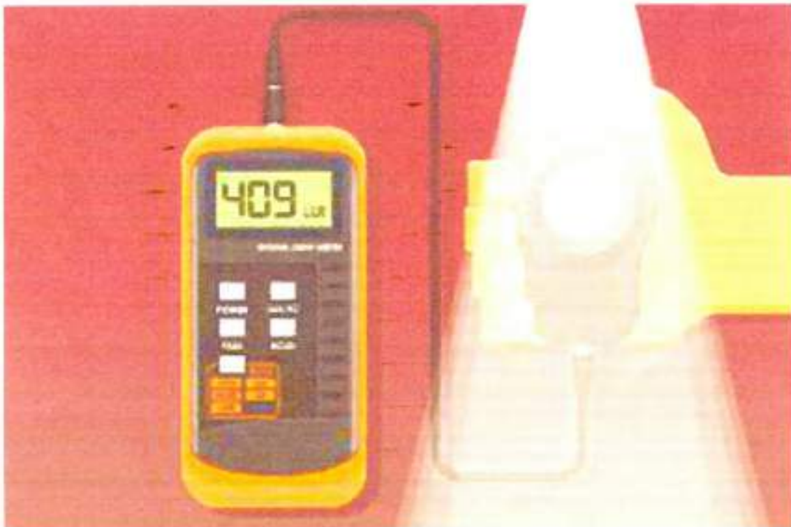
Gambar.E.4. Ilustrasi Lux Meter
