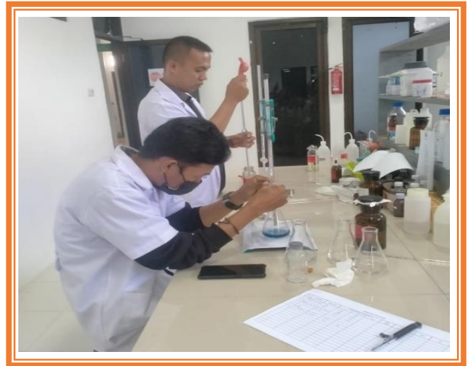
Pengujian parameter COD secara titrimetri
