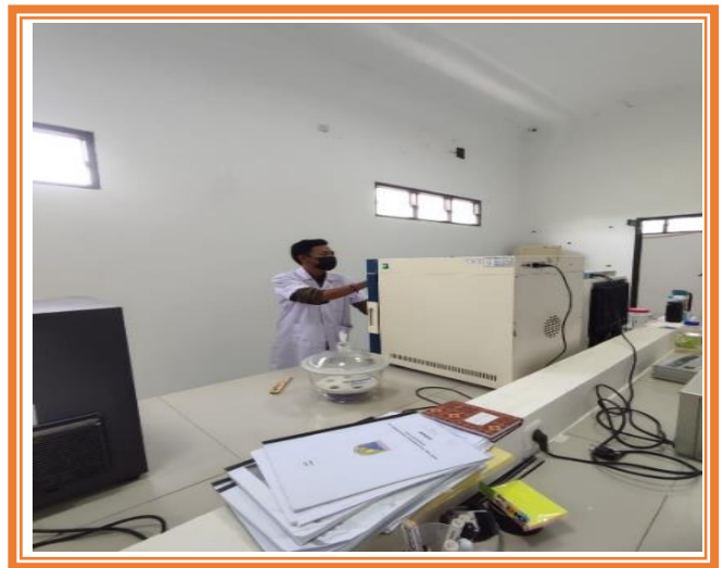
Penyaringan dan pemanasan sampel air untuk parameter TSS dan TDS
