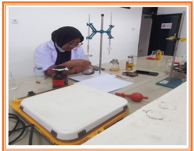
Pengujian parameter BOD secara titrimetri
