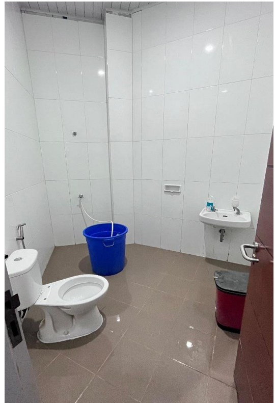
Gambar 10. Toilet Khusus dengan Toilet Duduk, Dapat dimasuki oleh Kursi Roda dan Mempunyai Pegangan
